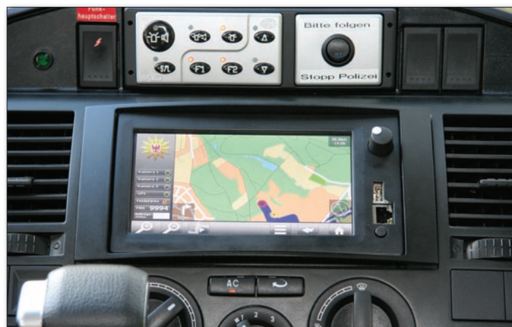
6 Navit kann als einziges evaluiertes Navigationssystem Kartenmaterialien im laufenden Betrieb wechseln und von außen zugehende POIs dynamisch einblenden.
