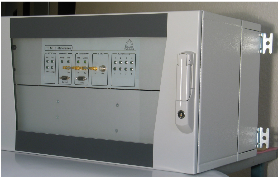
Bild 1: Zentrale Frequenzaufbereitung im Wandgehäuse
